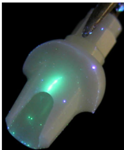
Индикация дефектов с помощью флуоресцентной капиллярной системы
