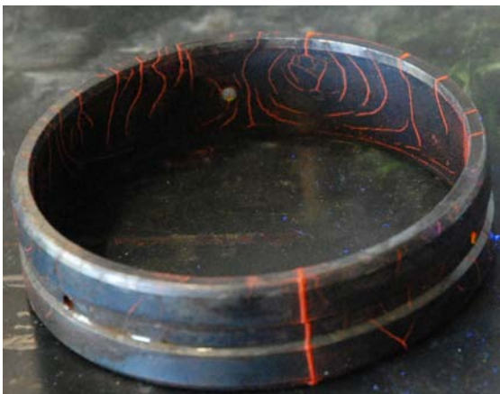
Индикация трещины, полученная при использовании водной суспензии на основе концентрата MEF 515
