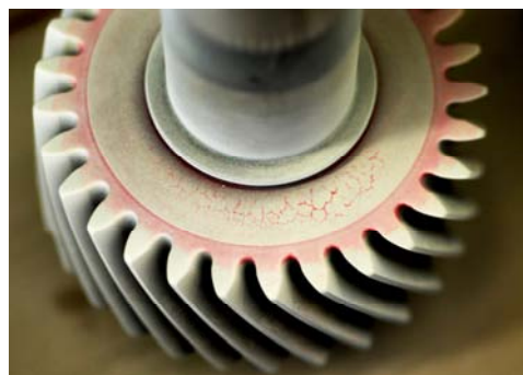
Индикация дефектов с помощью контрастной капиллярной системы
