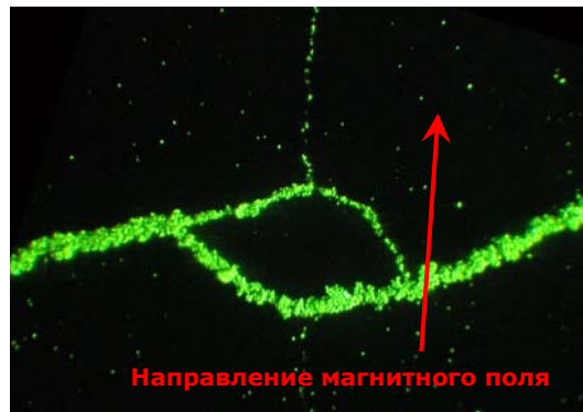
Индикация трещин методом флуоресцентного МК
